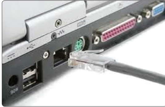
شكل (١-١): توصيل الحاسب بكابل بمقبس (RJ45) للشبكة المحلية
